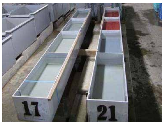
写真:増収型アトキンスふ化器。1槽当たり40万粒の卵を収容できる
